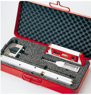
Die Meßgeräte ermöglichen ein maßgenaues Biegen von Radien und Steigungen.
