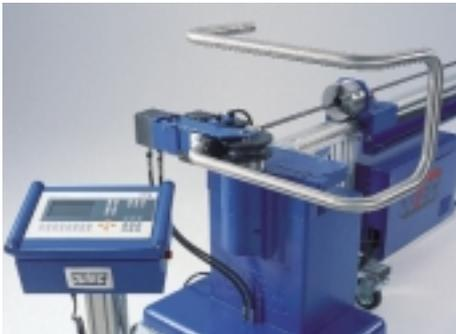
Jutec-Dornbiegermaschine Modell 5030, die besonders wirtschaftliche Biegeradien. Die kompakte Antriebseinheit mit dem lösbaren Dornträger bietet große Vorteile beim Einsatz am Montageort. Der freistehende Biegekopf lässt sich leicht für schwierige Geometrien auf **Rechts- und Linksbiegen** umbauen.
