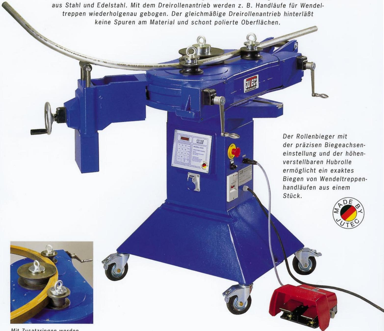
Der Rollenbieger mit der präzisen Biegeachsen-einstellung und der höhenverstellbaren Hubrolle ermöglicht ein exaktes Biegen von Wendeltreppenhandläufen aus einem Stück.
